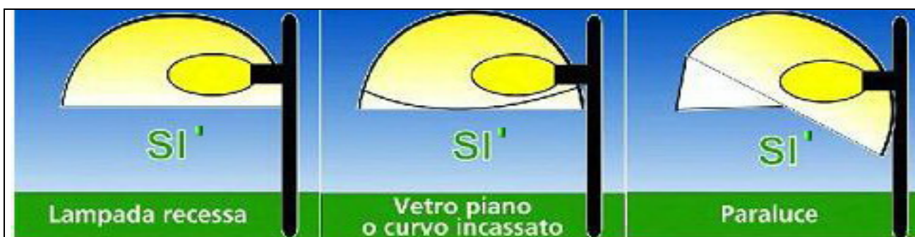
Figura 2.2 – Tipologie di apparecchi conformi alla legge n. 17/09 (cortesia: CieloBuio)
