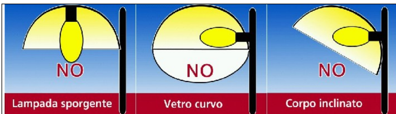
Figura 2.1 – Tipologie di apparecchi non ammessi (cortesia: CieloBuio)
